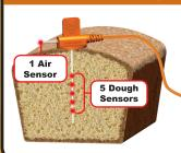
Breadometer® resuelve el problema de la inserción de las termocuplas de una forma aleatoria, al usar solo una pieza de 6 canales, diseñada de tal manera que logra ubicar las áreas mas frías dentro del producto, no importando quien lo usa:
